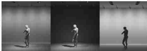
图 11 左图为立体展陈品的重点照明（主光与辅助光）和环境照明，中间为立体展陈品的重点照明（主光与辅助光），右图为仅为立体展陈品的环境照明，形成剪影效果
