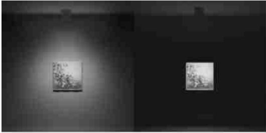
图 4 左图为柔和光光照效果，右图为加装光学遮片的灯具光照效果
